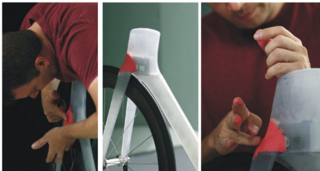
Jemné úpravy tvaru přímo ve větrném tunelu.
