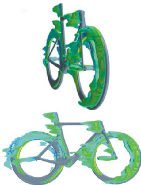
Vizualizace míst kde vzniká aerodynamický odpor
