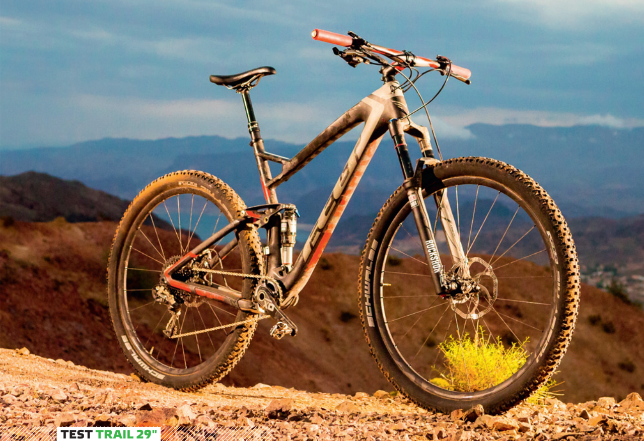
Odpruženie Equilink eliminuje pohodjovanie prepojením oboch vahadiel
